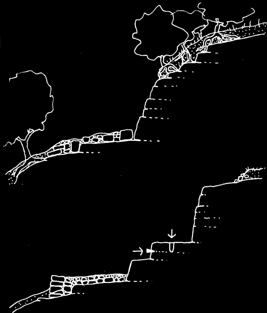
otvaranje kamenoloma i vađenje kamenog bloka
